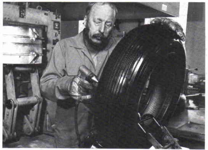
Det regummerade däckets punkteras halvvägs in i stommen för att avleda den luft som genom diffusion tränger in i stommen.
