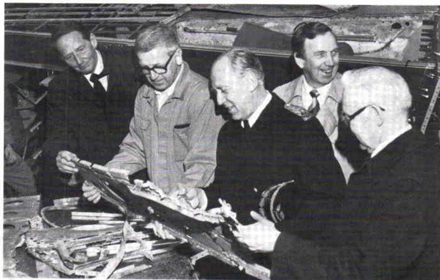
Saab-Scania's Olle Wirén, CFV Dick Stenberg, museichefen Axel Carleson och B 18-konstruktören Kenneth Lindqvist orienteras av plåtslagare Yngve Ovmark om hur han och hans medarbetare på FFV-U reparerar mittvingen. Det går åt mycket ny plåt för att åstadkomma ett säkert utställningsflygplan av haveristen.
