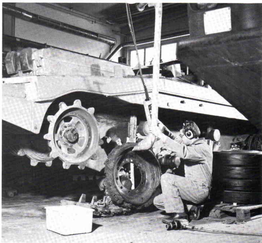
Ett kraftigt skadat bärhjul tas bort från en stridsvagn vid FFV-U i Linköping där man också gör modifieringar på dessa.
