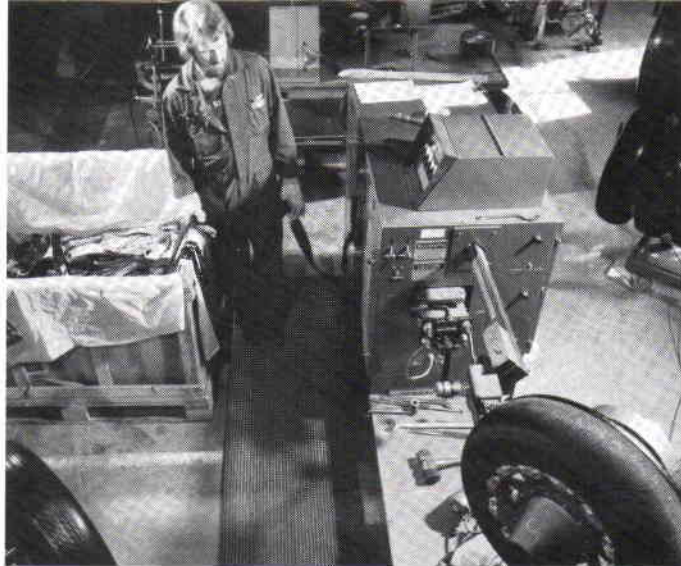
Sedan man sprutat på solution läggs slitbanan på i denna halvautomatiska maskin. Skiktets tjocklek styrs genom ett förprogrammerat hålkort.
