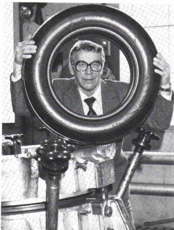
Genom en kraftig nedfrysning görs gummibanan spröd och kan lätt slås bort varpå bärhjulet kratsas, blåstras och solutioneras. Bärhjulet med det skadade gummiskiktet finns under en kåpa av plåt.
