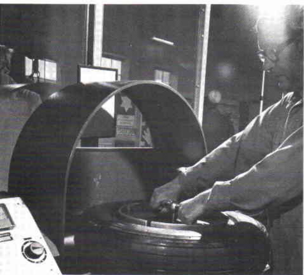
De regummerade däckena balanseras dynamiskt på konventionellt sätt i en maskin. Vid behov åtgärdas obalans med balanseringslappar som limmas på insidan.
