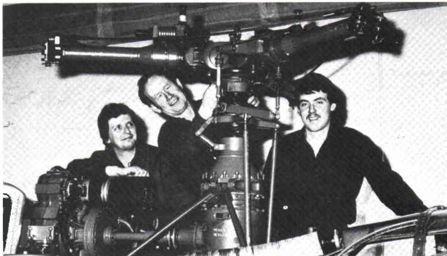
Montering av Hkp 2 rotormast i samband med G-tillsyn. Från vänster fanjunkare N-A Andersson, montör Knut Boström och värnpliktige Kjell Johansson.
